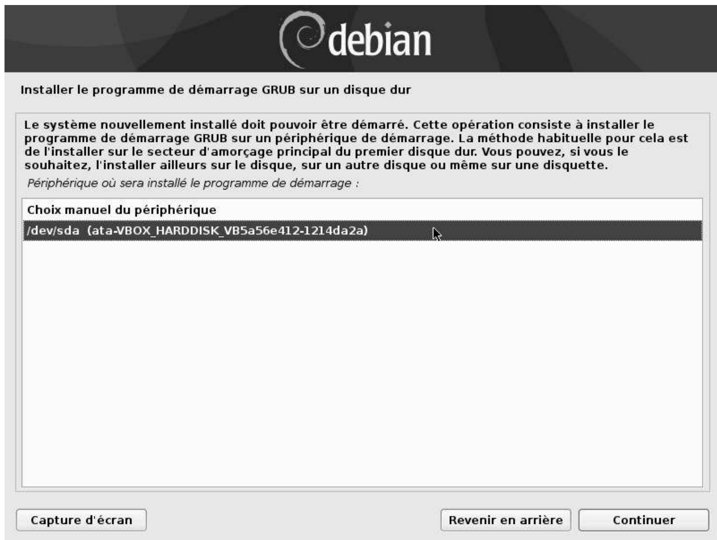
Installation : choix du disque pour GRUB
